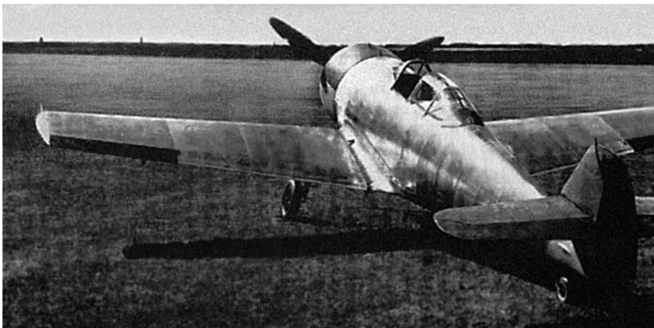
Опытный Fw-190X V-1 с мотором воздушного охлаждения, 1938 год.
