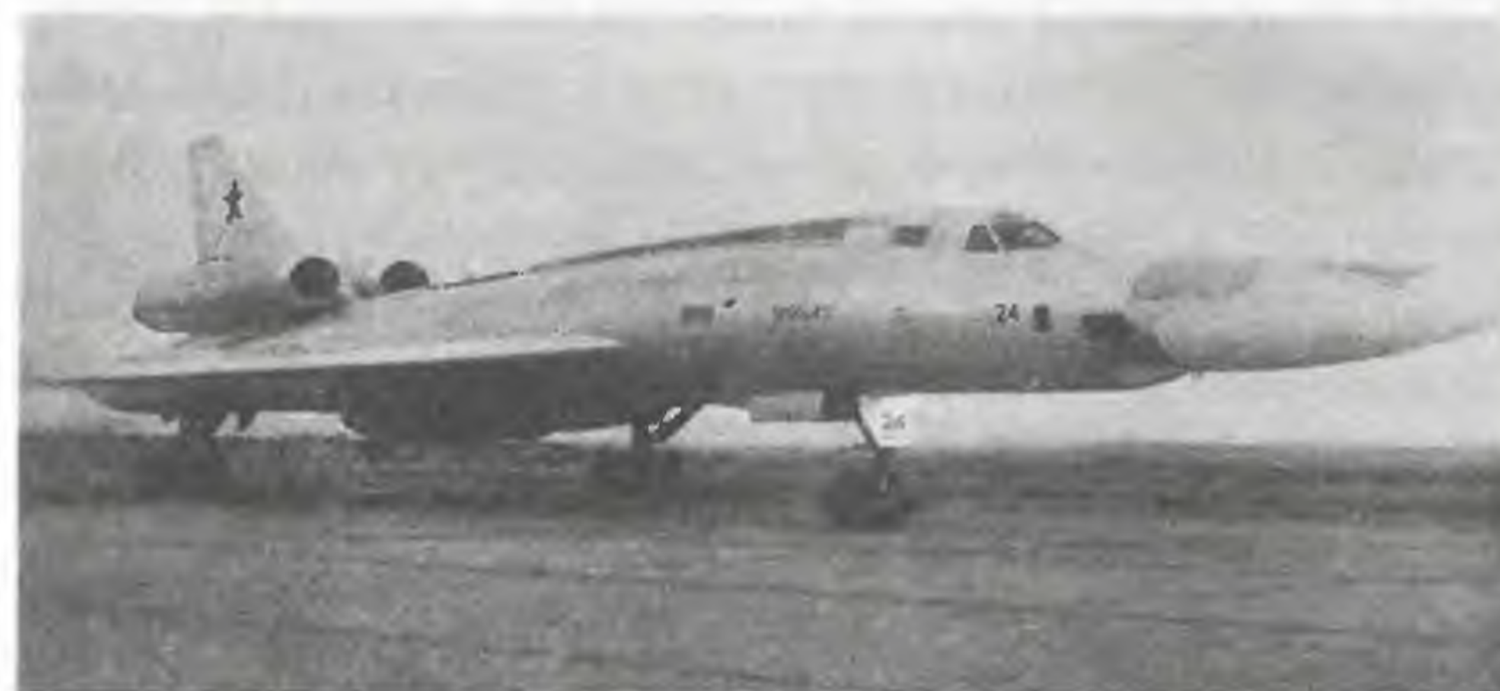
Самолет Ту-22К с ракетой Х-22 в бомбоотсеке
