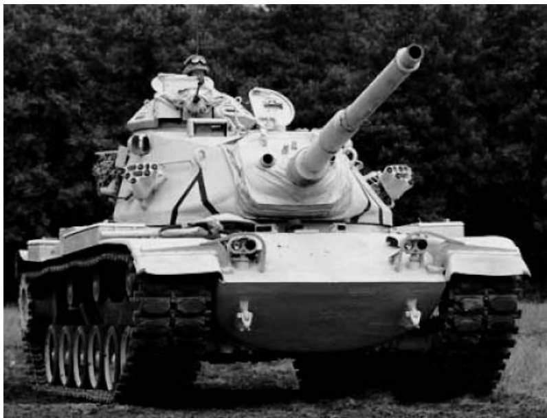
Американский танк М60 . Пушка калибра 105 мм. Фото из сети Интернет
