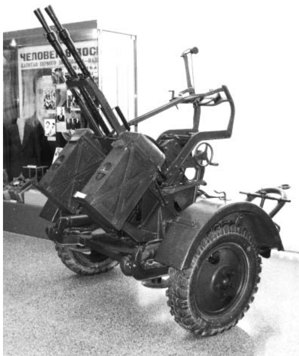
ЗПУ-2 калибра 14,5 мм (патрон 14,5x114 мм). Фото Геннадий Шубин
