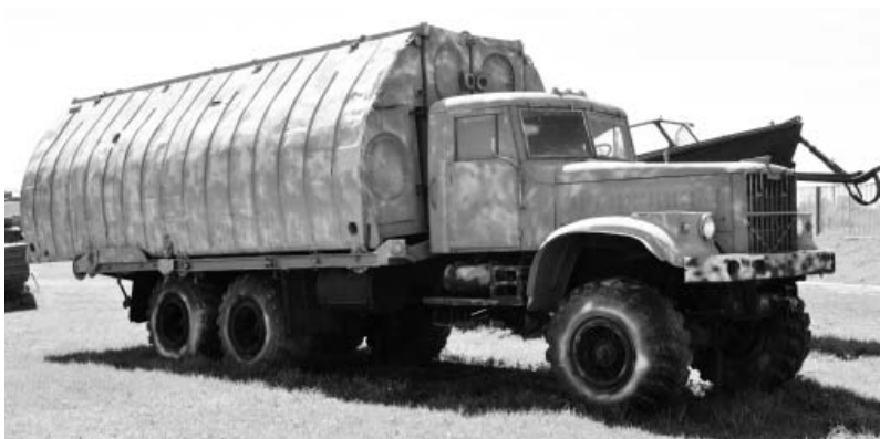
Пантоноукладчик ПМП на шасси КРАЗ-255 . Фото Вячеслав Барабуля
