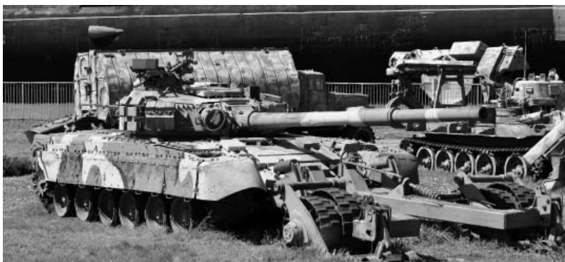
Т-80У с минным тралом. Пушка калибра 125 мм. Фото Вячеслав Барабуля
