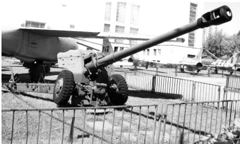
Д-74 калибра 122 мм. Дальность выстрела – до 24 км. Фото Виктор Лызлов
