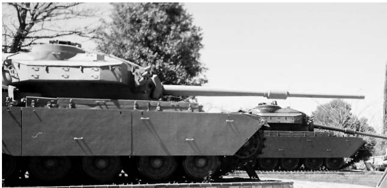
Танки Центурион английского производства с пушкой калибра 105 мм. Фото Ян Либенберг
