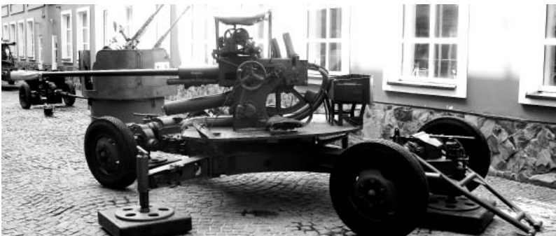
Спаренная зенитная установка В-47 калибра 37 мм. Фото Геннадий Шубин
