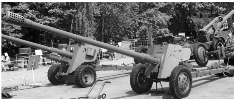
Д-48 калибра 85 мм. Дальность выстрела – до 18,9 км. Фото Виктор Лызлов
