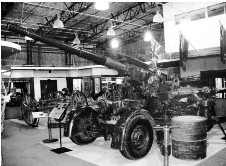
Скорострельное орудие ПВО калибра 3,7 дюйма (94 мм) английского производства. Возможно применялось в Африке с 1954 г. Фото Геннадий Шубин
