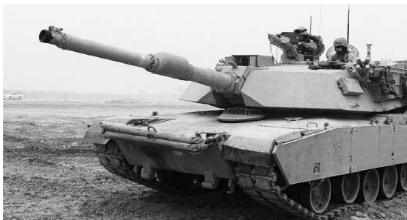
Американский танк М1 Абрамс . Пушка калибра 120 мм. Фото из сети Интернет
