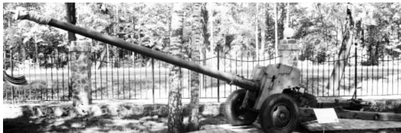
Пушка гладкоствольная Т-12 (2А19) Рапира калибра 100 мм. Дальность выстрела – 8,2 км. Фото Геннадий Шубин
