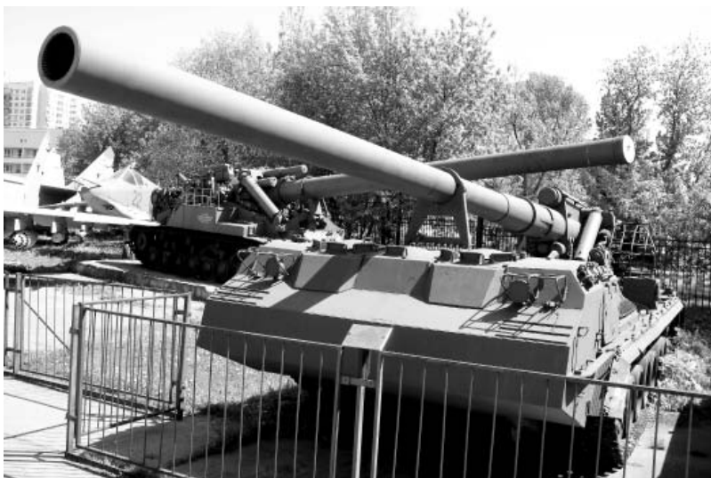
САУ 2С7 Пион . Пушка калибра 203 мм, дальность выстрела от 35 до 47 км. Фото Виктор Лызлов
