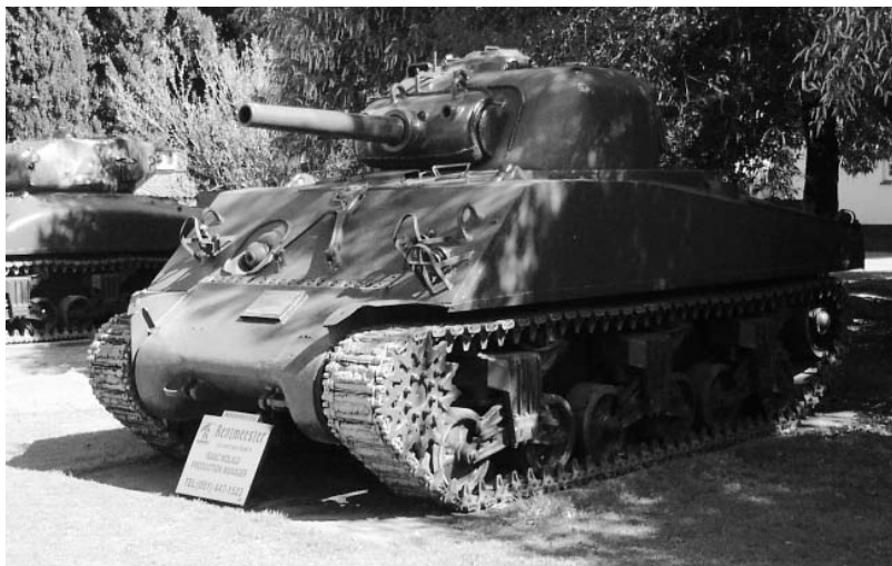
Танк Шерман М4/105 . Пушка калибра 105 мм. Фото Ян Либенберг
