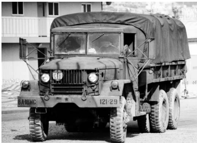
Грузовик М35 американского производства грузоподъёмностью в 2,5 тонны. Фото из сети Интернет
