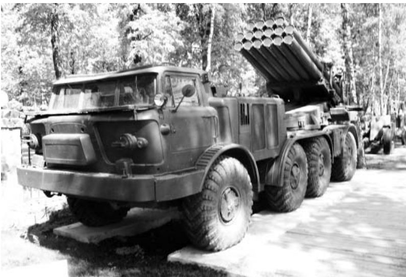
БМ-27 Ураган (16 направляющих калибра 220 мм). Дальность пуска ракет до 35 километров. Фото Геннадий Шубин
