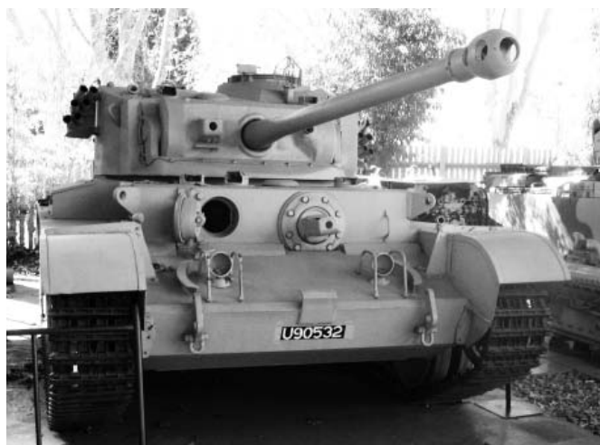
Британский танк Комета пушка калибра 77 мм. Фото Геннадий Шубин
