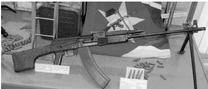
Автомат РПК-74 калибра 5,45 мм (патрон 5,45х39 мм). Фото Геннадий Шубин
