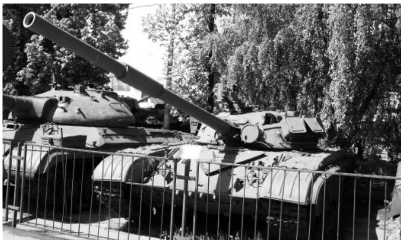
Т-64А. Пушка калибра 125 мм. Фото Виктор Лызлов
