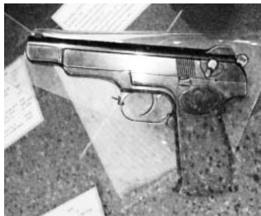
АПС Стечкин калибра 9 мм (патрон 9x18 мм). Фото Геннадий Шубин
