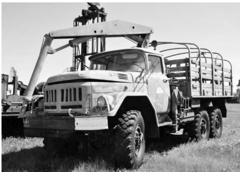
ЗИЛ-131 крановый самопогрузчик. Фото Вячеслав Барабуля
