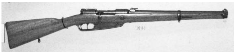
Немецкий карабины Маузер образца 1898 г. калибра 7,92 мм . Фото Геннадий Шубин
