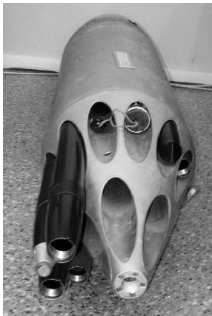
Блок УБ-16 (16 неуправляемых ракет калибра 57 мм) с истребителя МиГ-21 . Использовался в наземных боях установленный на бронетехнике
