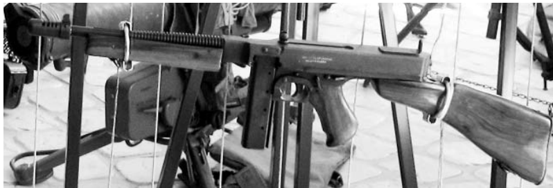
Автомат Томпсон калибра 11,43 мм (11,34x23 мм) американского производства. Фото Геннадий Шубин
