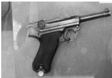
Пистолет Борхарда-Люгера производства Австро-Венгрии калибра 9 мм. Фото Геннадий Шубин
