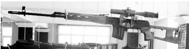
Снайперская винтовка Драгунова (СВД) калибра 7,62 мм (патрон 7,62x54 мм). Фото Геннадий Шубин
