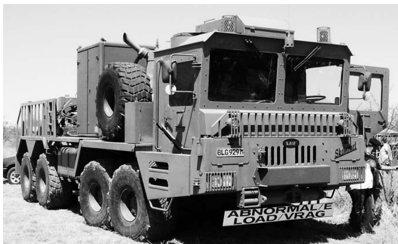
Тяжёлый частично бронированный тягач испанского производства Skimmel на вооружении армии ЮАР. Фото Ян Либенберг
