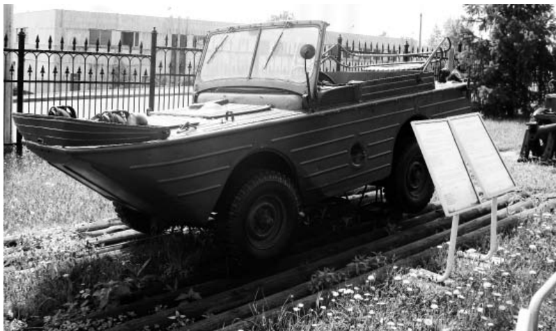
Лёгкая амфибия США Утка на шасси Форд GPW. Фото Геннадий Шубин
