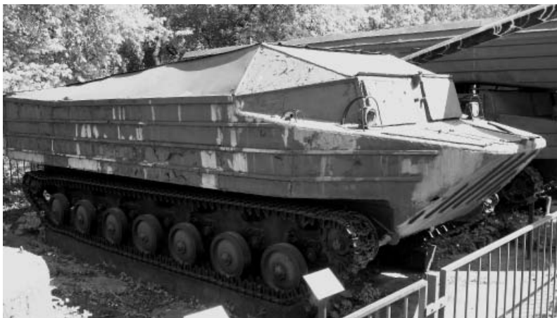
К-61 гусеничный плавающий бронетранспортер (использовался в Египте). Фото Геннадий Шубин
