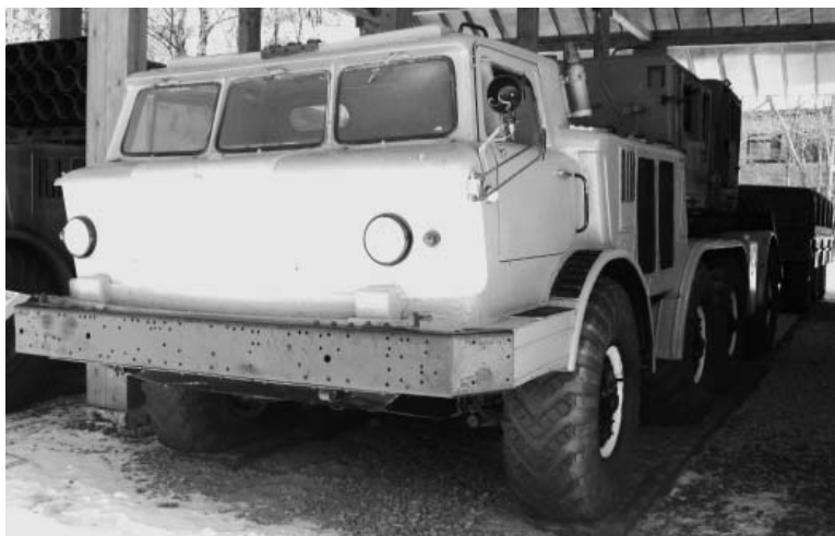
ЗИЛ135ЛМ. Грузоподъёмность девять тонн, двигатель бензиновый. Фото Геннадий Шубин
