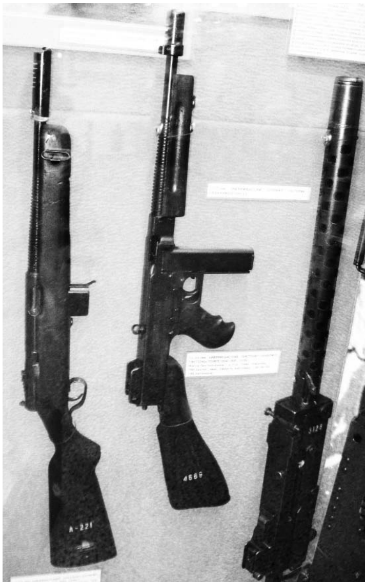
Американское оружие (слева направо): пистолет-пулемёт Рейзинг М60 образца 1940 г. калибра 11,43 мм; пистолет-пулемёт Томпсона образца 1928 г. калибра 11,43 мм и пулемёт Браунинг М1919 калибра 7,62 мм (патрон 7,62x51). Фото Геннадий Шубин
