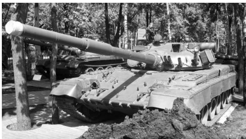
Т-80Б. Пушка калибра 125 мм. Фото Геннадий Шубин
