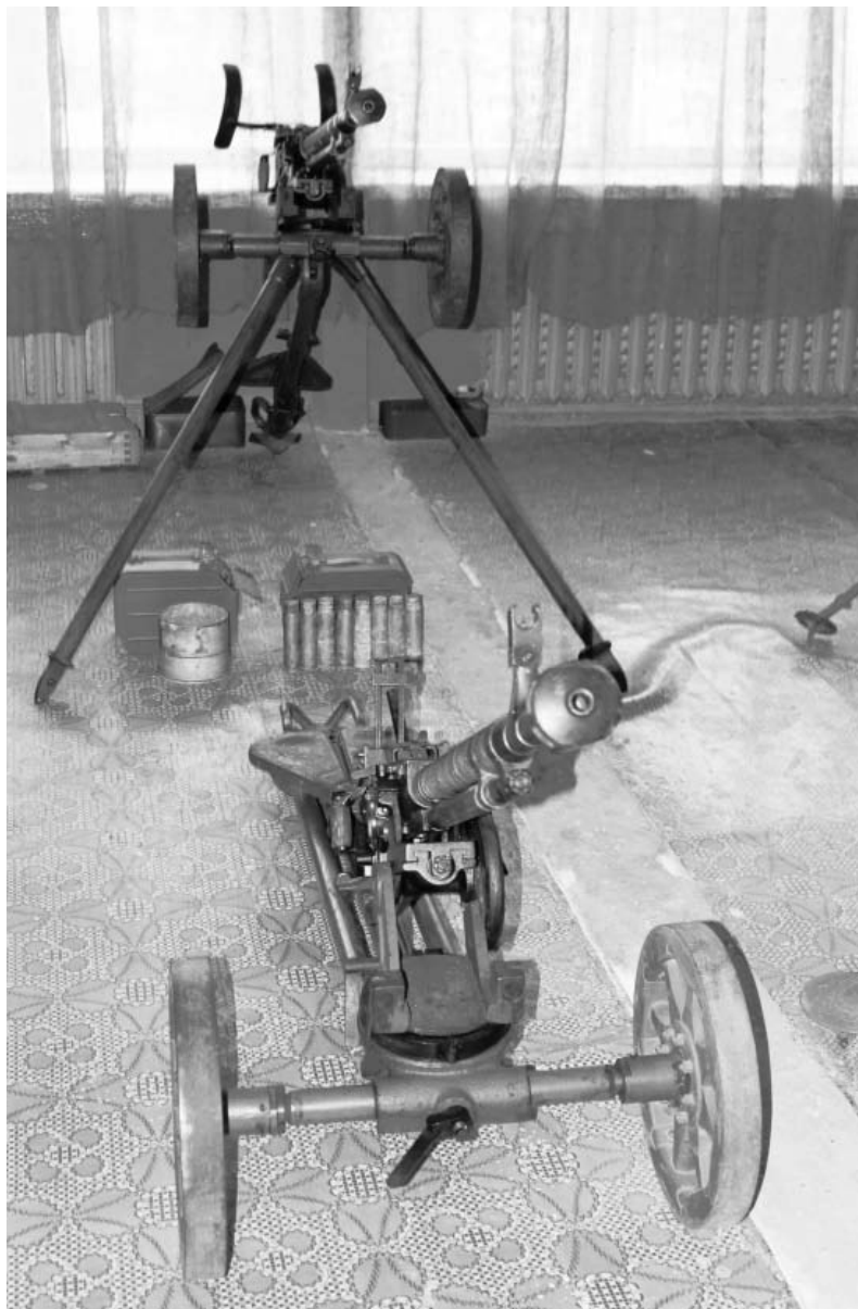
ДШКМ (два типа) калибра 12,7 мм образца 1946 г. (патрон 12,7x108 мм). Фото Геннадий Шубин
