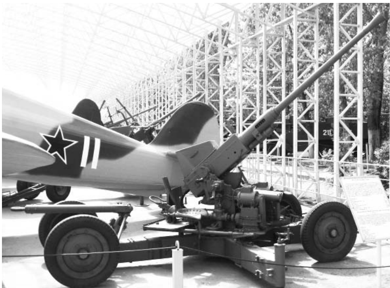
Скорострельное орудие ПВО Бофорс Мк II английского производства калибра 40 мм. Фото Геннадий Шубин
