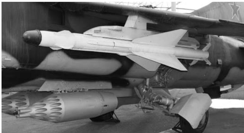
Р-23 (дальность пуска до 35 километров) и С-8 (20 неуправляемых ракет калибра 80 мм) истребителя-бомбардировщика Миг-23 . Фото Геннадий Шубин
