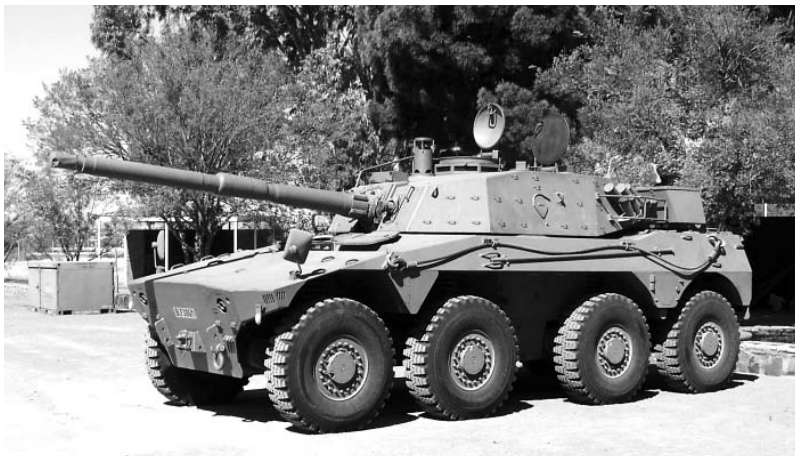
Бронетранспортёр Руикат-76 производства ЮАР. Пушка калибра 76 мм. Фото Ян Либенберг
