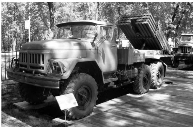
Град-1 калибра 122 мм на 36 направляющих на шасси ЗИЛ-131. Возможно применялся в Африке. Фото Геннадий Шубин
