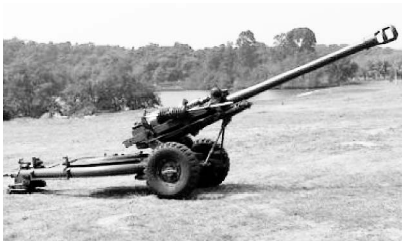
Артиллерийское орудие L118 калибра 105 мм английского производства. Фото из сети Интернет
