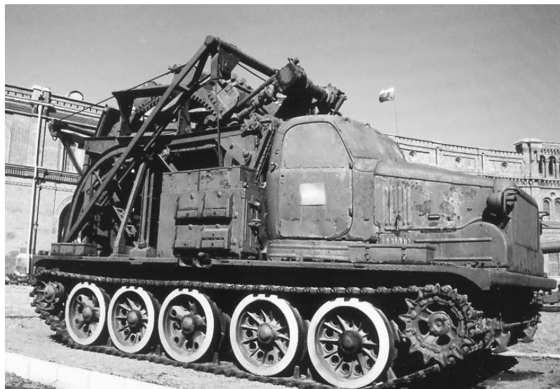
Быстроходная траншейная машина (БТМ). Фото Елена Субботина
