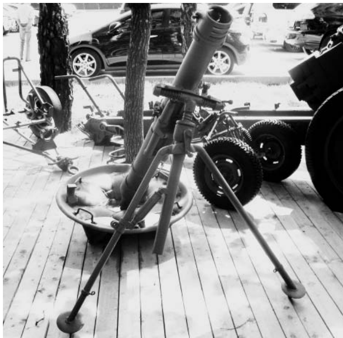
120 мм полковой миномет образца 1943 г. Фото Геннадий Шубин
