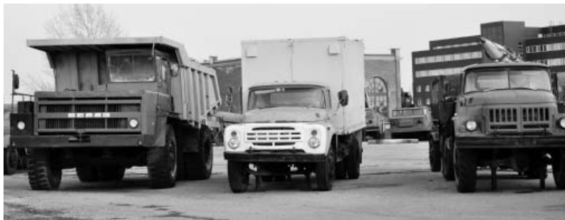
Слева-направо карьерный самосвал Белаз (грузоподъёмностью в 30 тонн), ЗИЛ-130 и ЗИЛ-131 . Фото Вячеслав Барабуля
