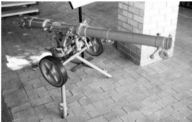
Безоткатное орудие Б-10 калибра 82 мм. Фото Геннадий Шубин
