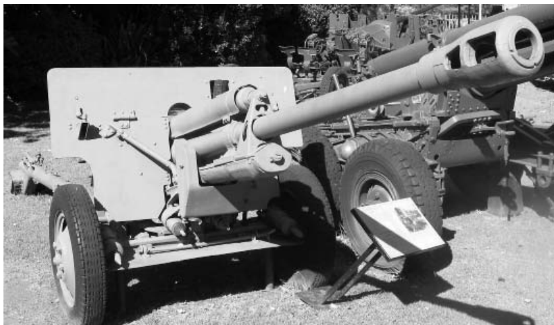
ЗИС-3 калибра 76 мм. Дальность выстрела – 13,3 км. Фото Геннадий Шубин
