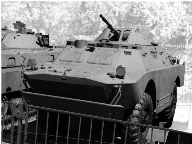
БРДМ-2. Пулемёт КПВТ калибра 14,5 мм (14,5х114 мм). Фото Виктор Лызлов
