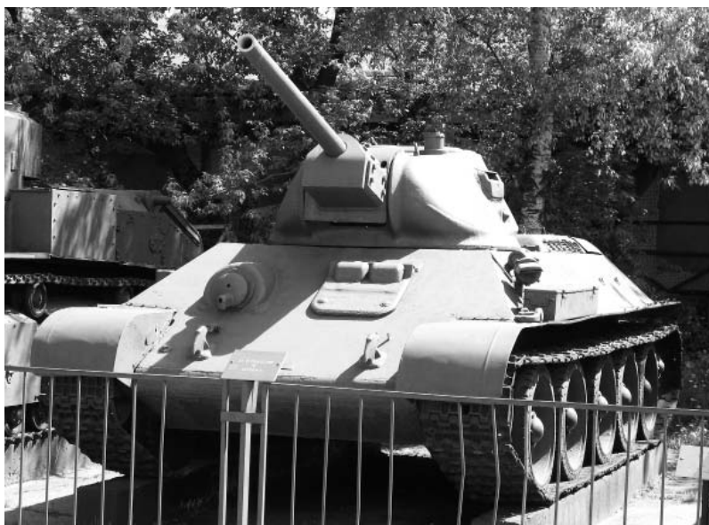
Т-34-76. Пушка калибра 76 мм. Фото Виктор Лызлов
