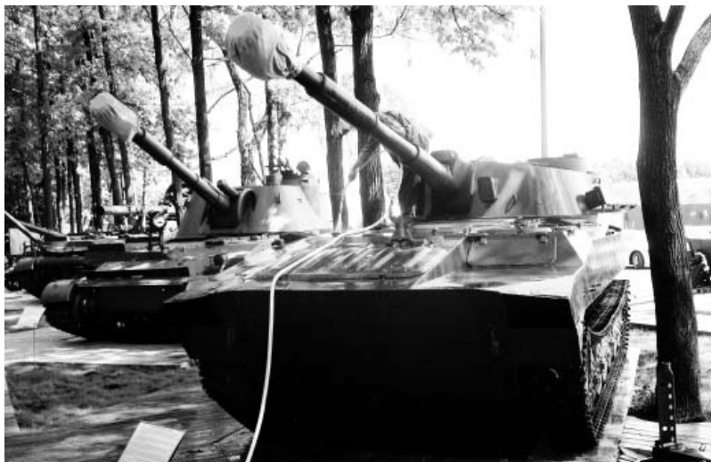
САУ Гвоздика. Пушка калибра 122 мм. Дальность выстрела до 15,2 км. Фото Геннадий Шубин
