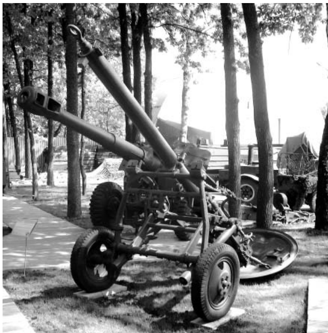
160-мм миномет образца 1943 г. (МТ-13) . Дальность выстрела – 5,1 км. Фото Геннадий Шубин
