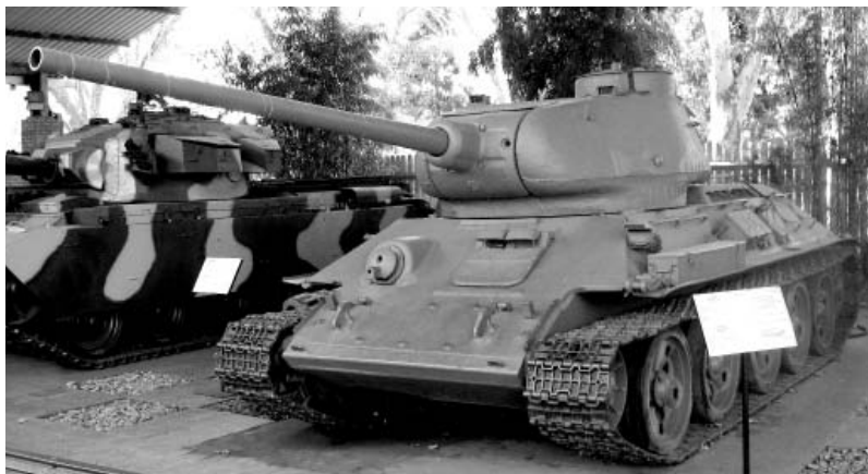
Т-34 (Т-34-85). Пушка калибра 85 мм. Фото Геннадий Шубин
