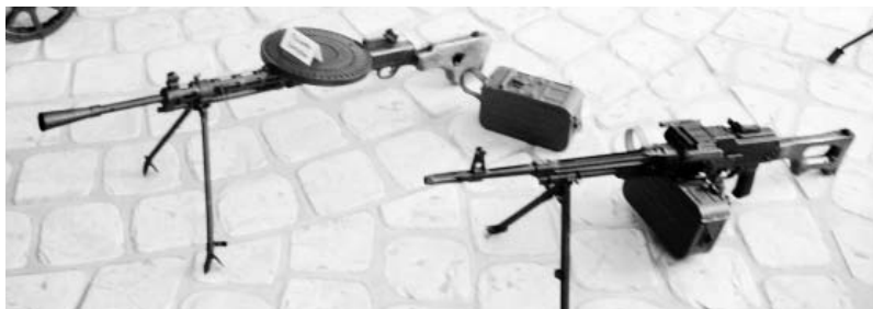
Слева направо: ручные пулемёты Дегтярёва и Калашникова (ПКМ) калибра 7,62 мм (патрон 7,62x54 мм). Фото Геннадий Шубин
