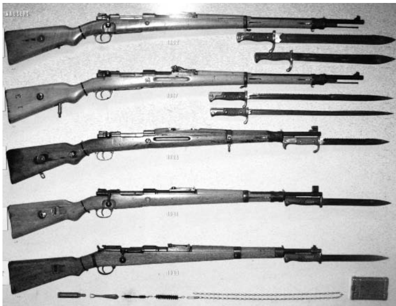
Винтовки Маузер производства кайзеровской и фашистской Германии калибра 7,92 мм (патрон 7,92x57 мм).
