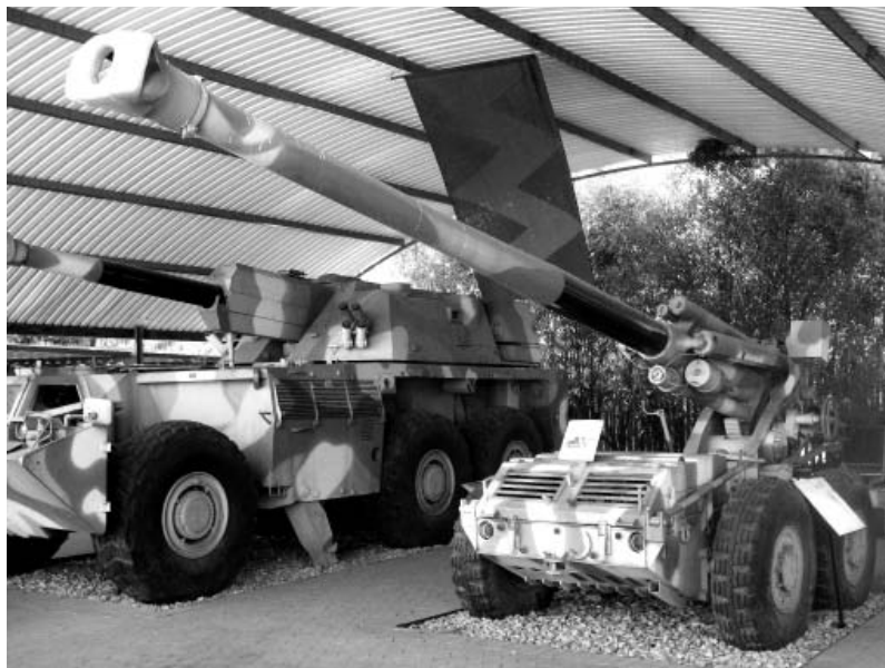
Г-5 дальнобойная гаубица южноафриканского производства. Дальность выстрела – 39 км. Фото Геннадий Шубин
