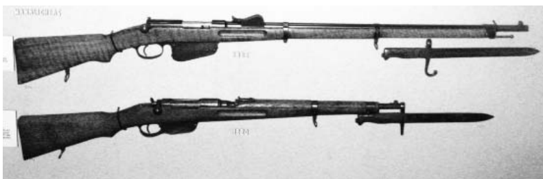
Винтовки Манлихер производства Австро-Венгрии и Австрии калибра 11 мм и 8 мм.
