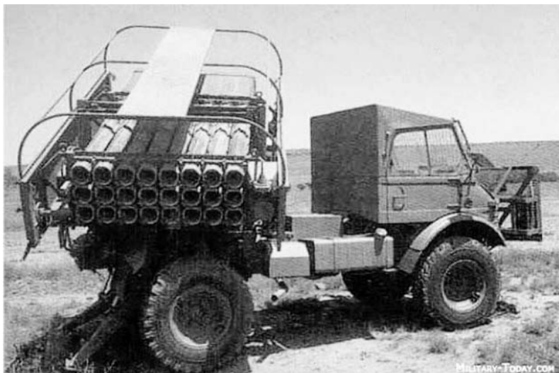
РСЗО Валькирия Mk I южноафриканского производства (24 направляющих калибра 127 мм). Дальность стрельбы до 22 км. Фото из сети Интернет
