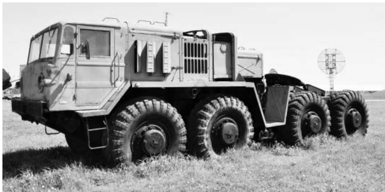
МАЗ-537 Г (Головастик) – тягач для перевозки танков. Фото Вячеслав Барабуля
