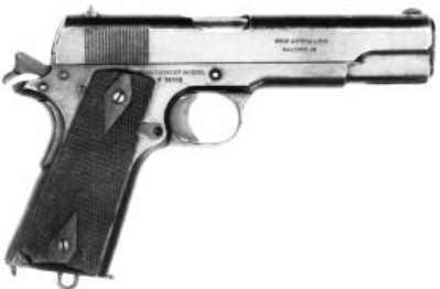
Пистолет Кольт 1911 американского производства калибра 11,43 мм. Фото из сети Интернет
