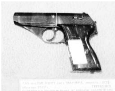
Маузер ХСЦ образца 1937 г. калибра 7,65 мм. Фото Геннадий Шубин
