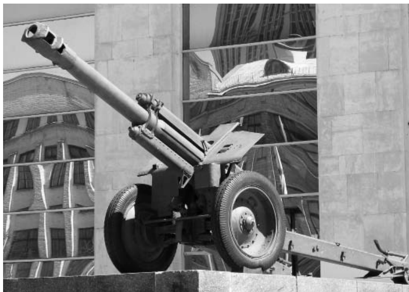
Гаубица Д-1 калибра 152 мм. Дальность стрельбы – до 12 км. Фото Виктор Лызлов
