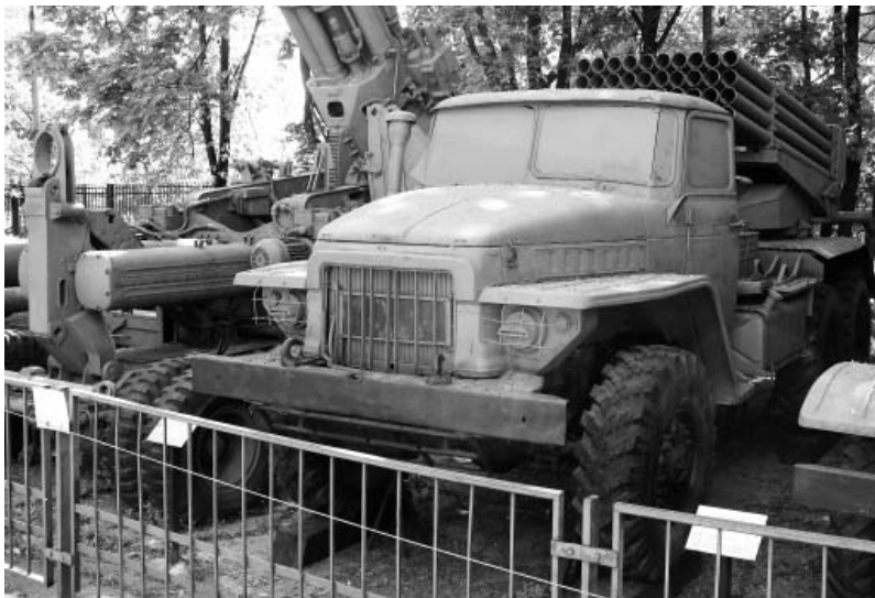
БМ-21 (40 направляющих калибра 122 мм). Дальность пуска ракет – до 21 км. Фото Виктор Лызлов
