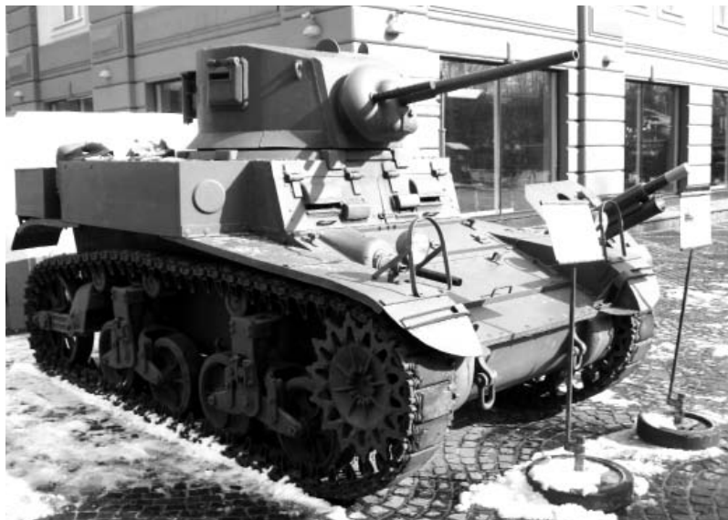
Американский танк М3 Стюарт . Пушка калибра 37 мм. Самый массовый лёгкий танк Второй мировой войны (в 1938–1941 было выпущено 23685 единиц). Использовался португальцами в Анголе. Фото Геннадий Шубин
