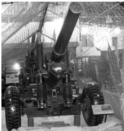
Английская гаубица Г-2 (пять-пять) (пять с половиной дюймов) калибра 140 (144) мм. Дальность выстрела – от 16,4 до 21 км (активно-реактивным снарядом). Фото Геннадий Шубин
