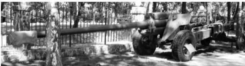
М-46 калибра 130 мм. Дальность выстрела – 27,5 км или до 38 км – активно-реактивным снарядом. Фото Геннадий Шубин
