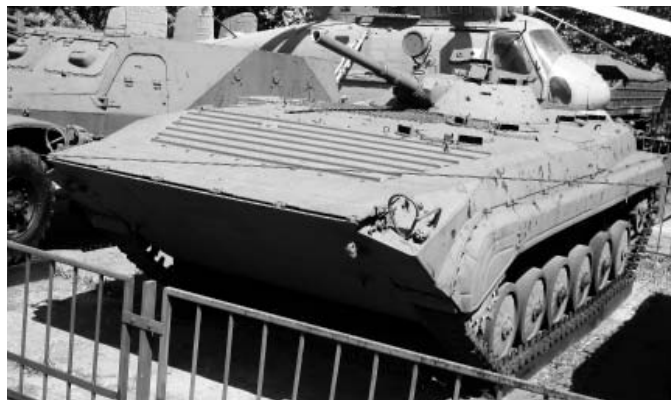
БМП-1 . Гладкоствольная пушка калибра 73 мм. Фото Геннадий Шубин
