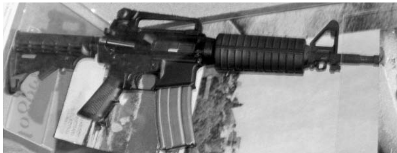
Американская штурмовая винтовка М-4 калибра 5,56 мм (патрон 5,56x45 мм). Фото Геннадий Шубин
