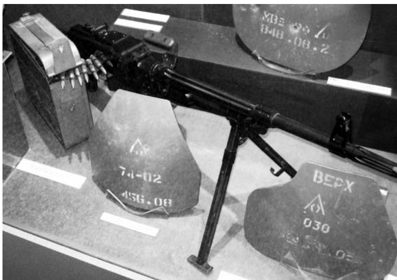
ПК (пулемёт Калашникова образца 1961 г. ) калибра 7,62 мм (патрон 7,62x54 мм). Фото Геннадий Шубин
