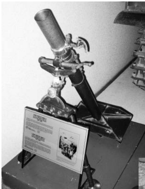
Британский миномёт Mark II калибра 76,2 миллиметра (3 дюйма). Дальность выстрела – 2,5 км. Производство ЮАР и Англии. Фото Геннадий Шубин
