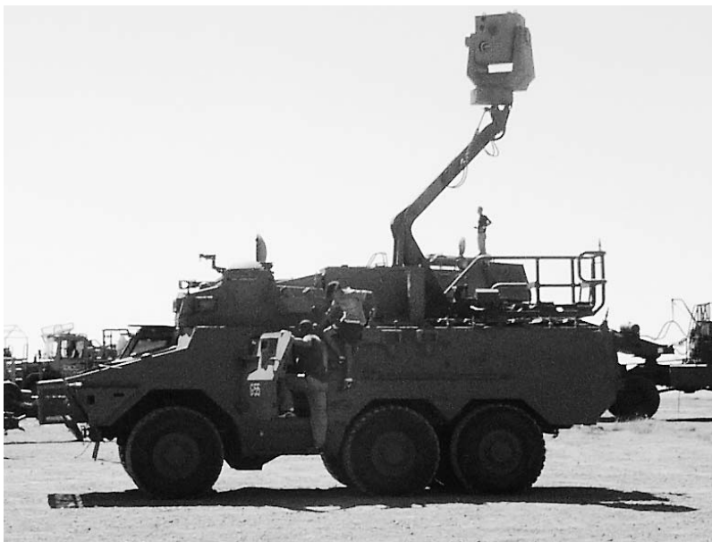
Система управления артиллерийским огнём на шасси бронетранспортёра Рател южноафриканского производства. Фото Ян Либенберг
