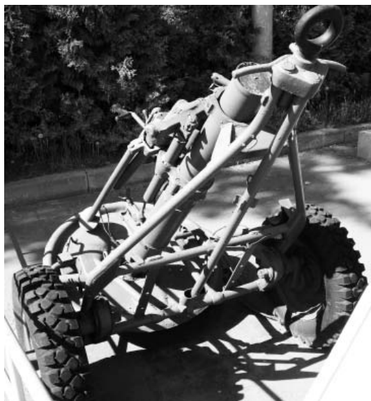
ЗПУ-2 калибра 14,5 мм (патрон 14,5х114 мм). Фото Геннадий Шубин
