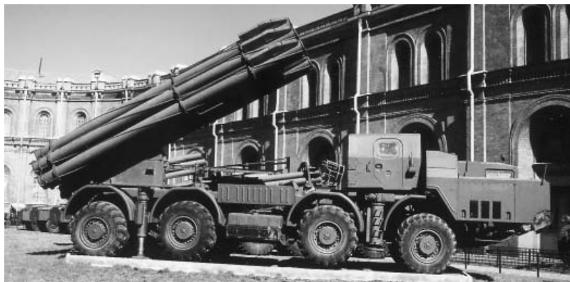
БМ-30 Смерч (12 направляющих калибра 300 мм). Дальность выстрела до 90 км. Фото Елена Субботина
