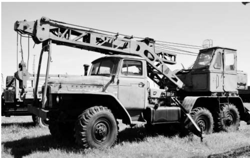
Кран автомобильный войскового назначения КС-2573 на шасси УРАЛ-4320. Фото Вячеслав Барабуля
