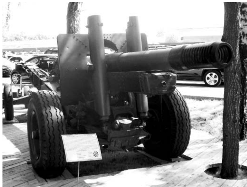
152 мм гаубица-пушка МЛ-20 образца 1937 г. Дальность выстрела – 17,2 км. Фото Геннадий Шубин
