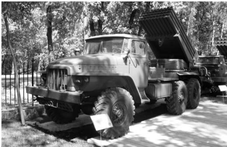
РСЗО БМ-21 (40 направляющих калибра 122 мм, дальность выстрела до 21 км) на шасси грузовика УРАЛ-375. Фото Геннадий Шубин
