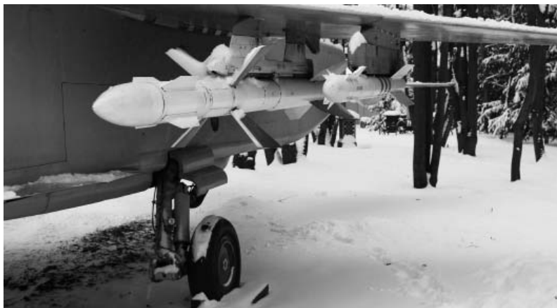
Р-27 (дальность пуска до 90 км) (слева) и Р-73 (дальность пуска до 40 км). Фото Геннадий Шубин
