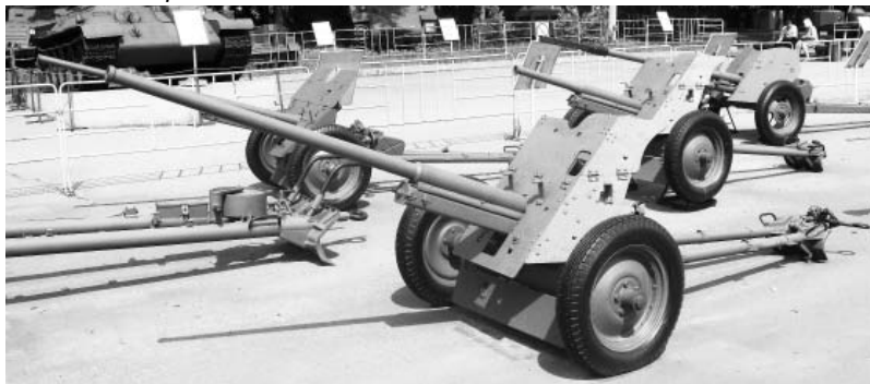
Противотанковая пушка М-42 (калибра 45 мм) ( сорокапятка ). Дальность стрельбы – 4,5 км. Фото Геннадий Шубин
