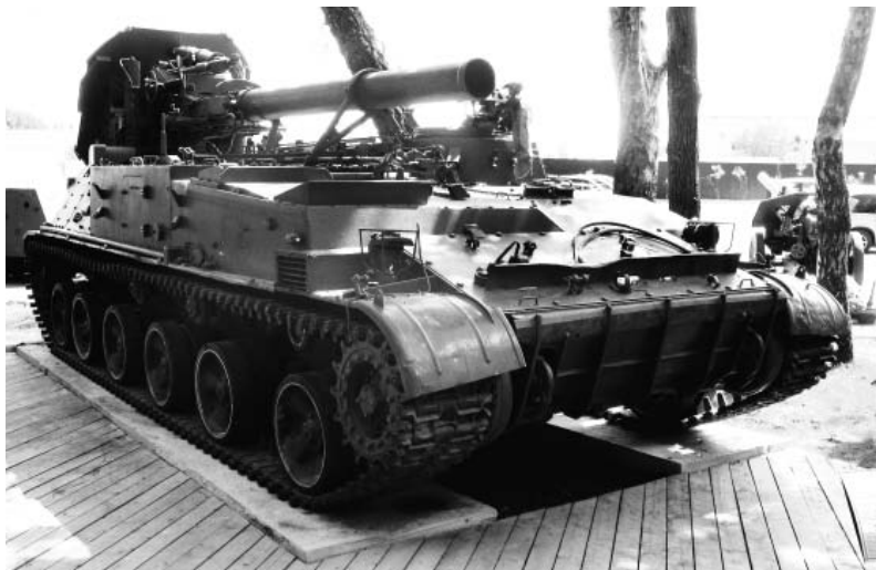
Самоходный миномет 2С4 Тюльпан . Пушка калибра 240 мм, дальность выстрела до 18 км. Фото Геннадий Шубин
