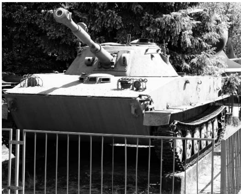
Плавающий танк ПТ-76 . Пушка калибра 76 мм. Фото Виктор Лызлов
