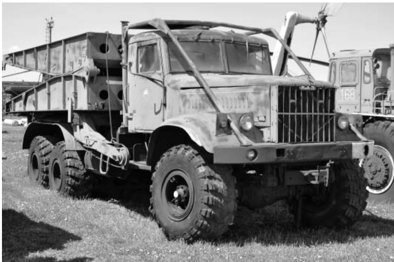
Тяжёлый механизированный мост (ТММ-3) на шасси КРАЗ-255Б . Фото Вячеслав Барабуля
