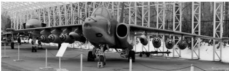
Штурмовик Су-25 и два НАР С-5 калибра 57 мм в блоке УБ-32-57 и четыре НАР С-8 калибра 80 мм в блоках Б-8 и пулемёты ГШ-23Л калибра 23 мм в блоках СППУ-22 . Фото Геннадий Шубин
