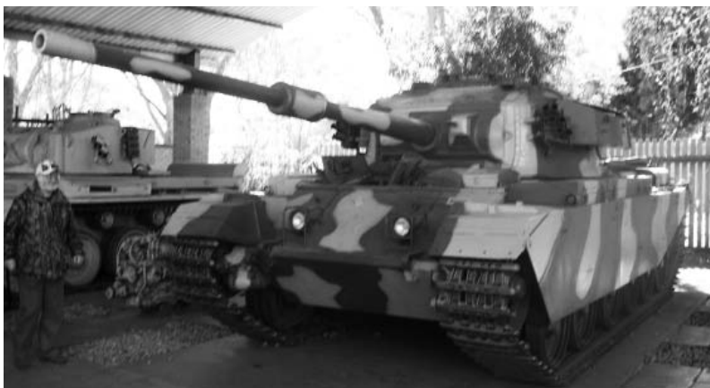
Английский танк Центурион с пушкой калибра 84 мм. Фото Геннадий Шубин
