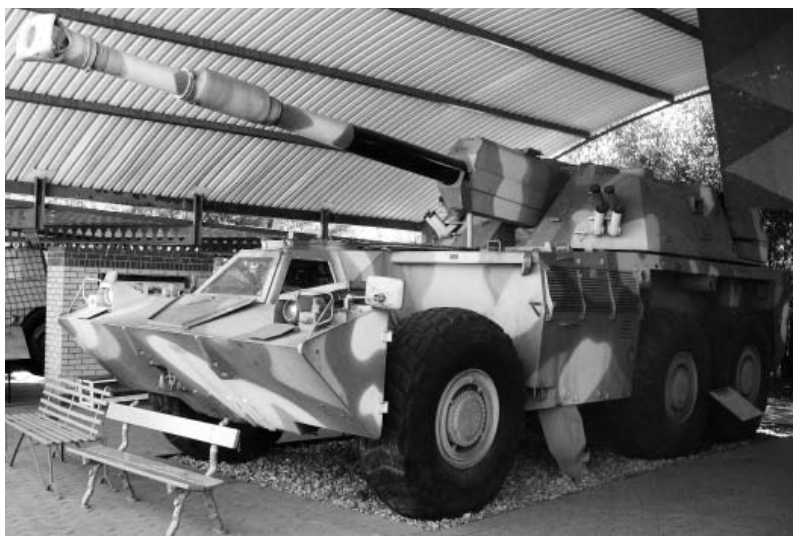
САУ Г-6 южноафриканского производства калибра 155 мм. Дальность – выстрела до 39 км. Фото Геннадий Шубин
