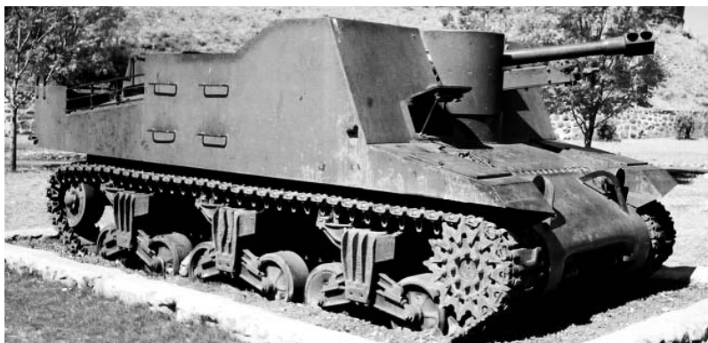
САУ Секстон (Sexton) канадского производства. Пушка калибра 87,6 мм (25 фунтов). Фото Ян Либенберг
