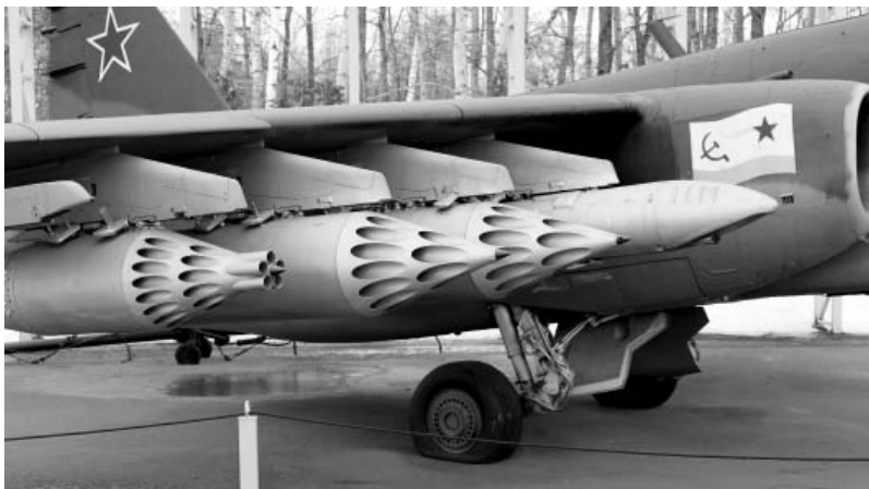
Штурмовик Су-25 и НАР С-5 калибра 57 мм в блоке УБ-32-57 и два НАР С-8 калибра 80 мм в блоках Б-8 и пулемёты ГШ-23Л в блоке СППУ-22 . Фото Геннадий Шубин
