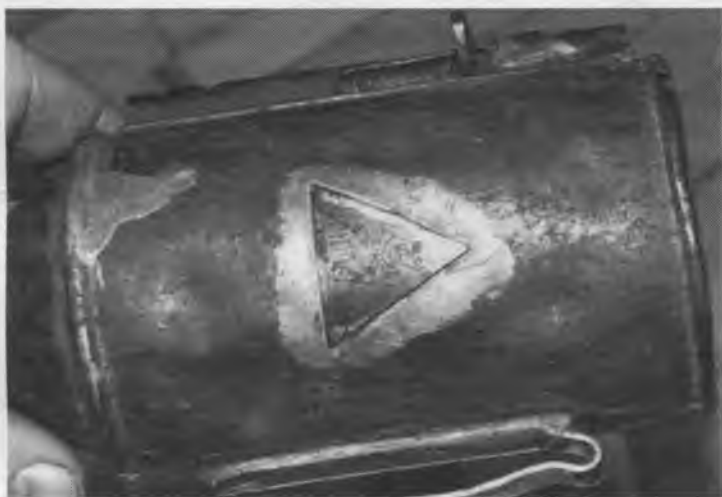
Ручная химическая граната обр.1914 г. (граната обр.1917 г.) с характерным знаком и надписью «ХИМИЧЕСКАЯ» на корпусе
