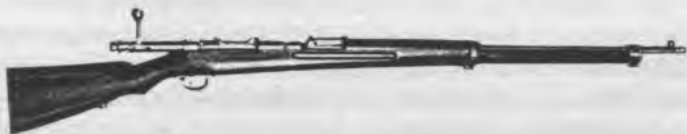
6,5-мм винтовка «Арисака» тип 30 Мэйдзи (затвор открыт)
