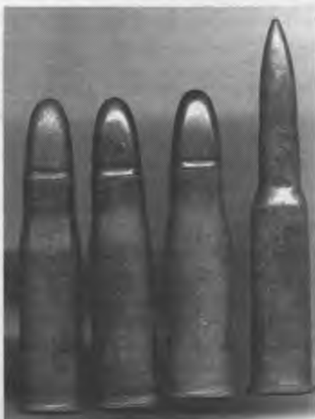
10,4-мм винтовочные патроны «Веттерли» в сравнении с русским 7,62-мм патроном обр.1908 г.
