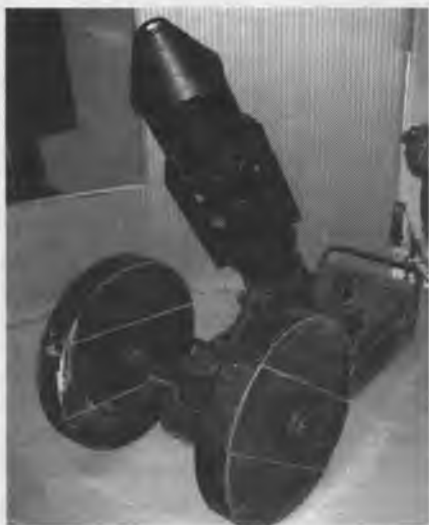
58-мм миномет «Ф.Р.» на деревянном станке с колесами Невского завода, с оперенной надкалиберной железной миной
