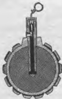
Французская ручная граната F.1 с дистанционным запалом ударного действия (капсюль разбивался ударом перед броском) и граната германского образца с терочным дистанционным запалом
