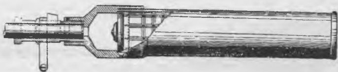
16-лин. ружейный гранатомет («мортирка») Карнаухова—Павловского—Сегаля с чугунной осколочной гранатой с дистанционной трубкой (от 1 до 10 сек)
