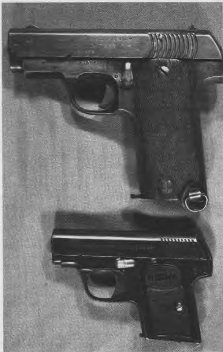
Эйбарские браунинги — 7,65 мм «Зулайка» модели 1914 г. и карманный 6,35 мм «Унион»
