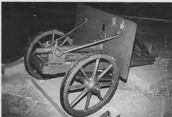
37-мм траншейная пушка обр.1915г. (системы Розенберга) легко разбиралась на три части, переносилась по траншеям или перекатывалась по полю расчетом, для установки требовалась небольшая площадка
