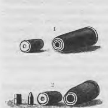
1) Видъ пули. 2) Пуля и патронъ въ разобранномъ видѣ. 3) Снаряженный патронъ съ пулей.
