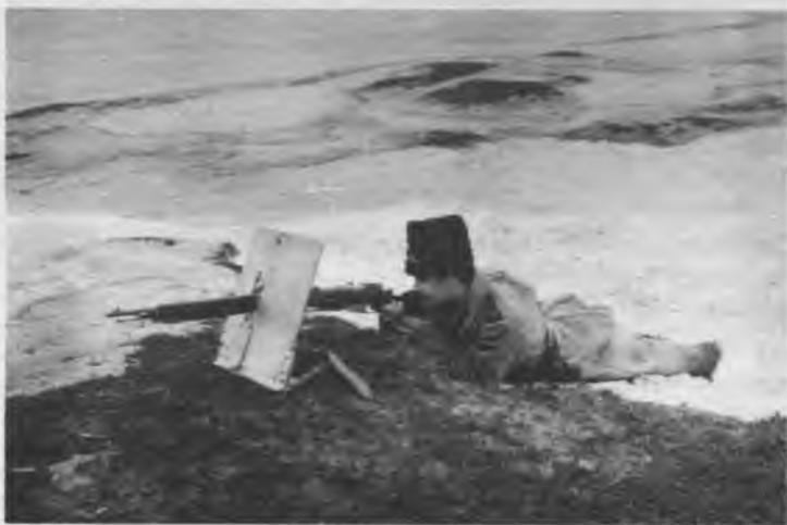
Испытание носимого стрелкового щита. Нижний Новгород, 1915 г.
