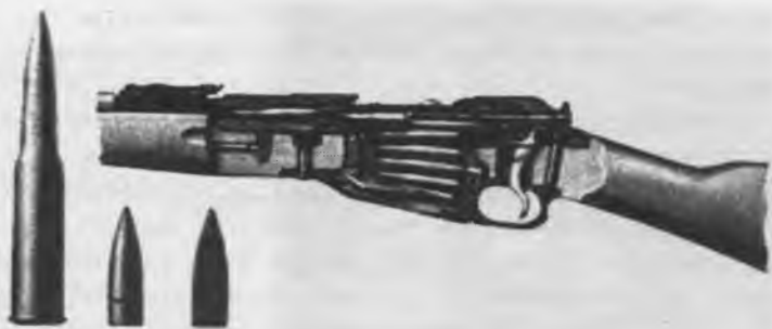
Разрез механизмов «трехлинейки» (в варианте обр. 1891/30 гг.). Рядом — разрез легкой остроконечной пули патрона обр. 1908 г.
