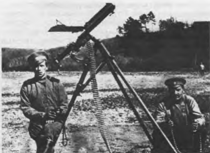
Трофейный пулемет «Шварцлозе», приспособленный для зенитной стрельбы с помощью высокой треноги
