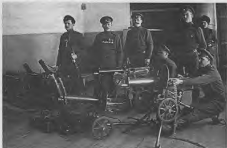
В войсковой мастерской, используемой для ремонта вооружения пулеметных и бомбометных команд. Любопытно разнообразие вооружения: пулеметы — на первом плане — «Максим» обр. 1910 г. на треножном станке «Виккерс» обр. 1910 г., за ним — на колесном станке Колесникова, далее — трофейный MG.08 на салазочном станке; бомбометы — трофейный германский и 9-см бомбометы типа «Г. Р.»
