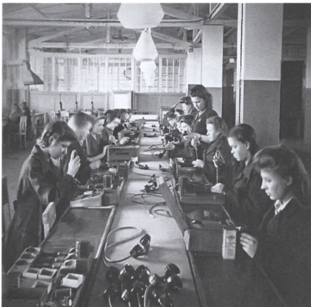
25 сентября 1942 г. Пущен конвейер по сборке полевых телефонных аппаратов УНАФ-41 на заводе № 629. Этот день считается днем рождения телефонного завода
