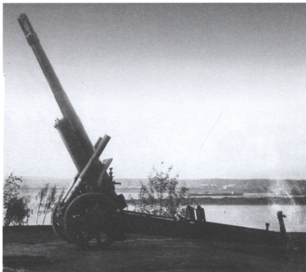
152-мм гаубица-пушка МЛ-20 конструкции завода. Калибр 152,4 мм, вес снаряда 43,56 кг, дальность макс. 17 265 м, вес 7250 кг
