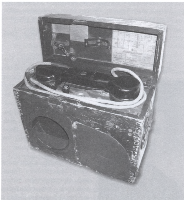
Продукция завода № 629 – полевые телефонные аппараты УНАФ-43
