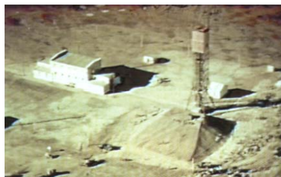
Центральная часть опытного поля перед испытанием РДС-6с. Заряд установлен на высоте 30 м.
