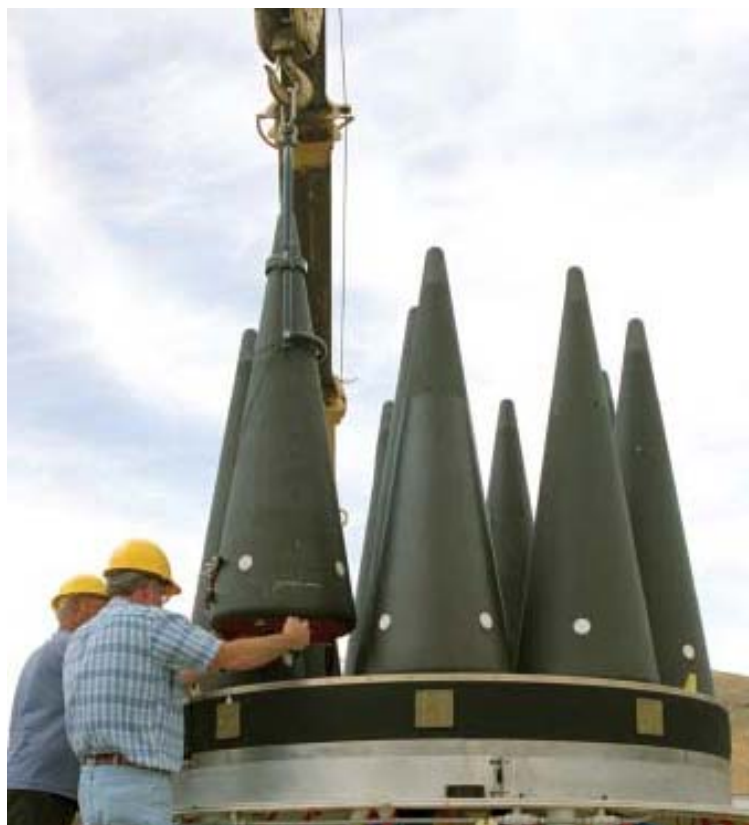
Установка БГ Мк-21 на головной части МБР МХ
